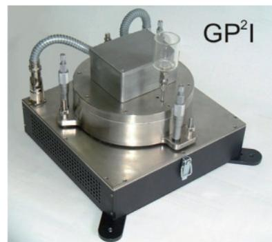
Plattenapparat zur Bestimmung der Wärmeleitfähigkeit
