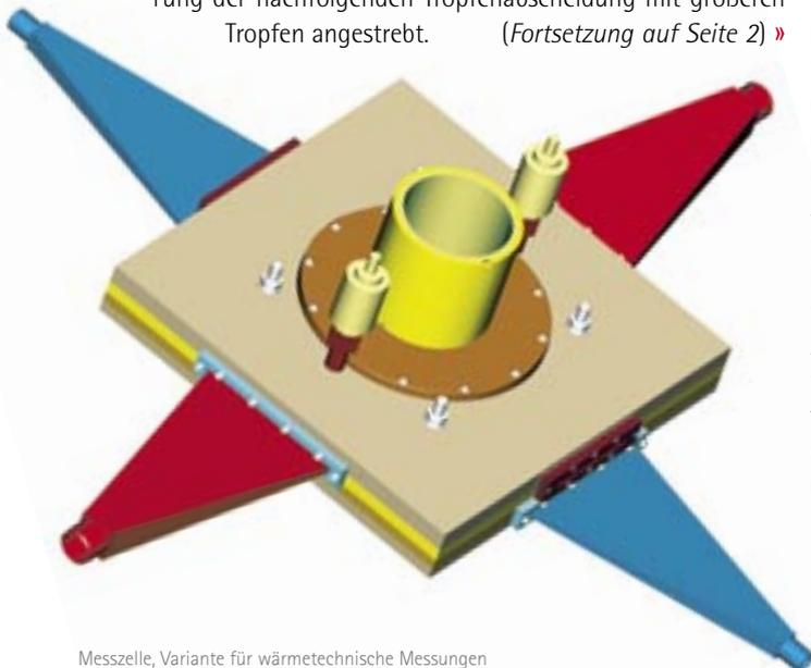
Messzelle, Variante für wärmetechnische Messungen
